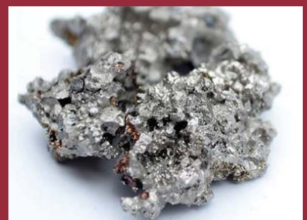
Ocelový kvet kera vznikajúci pri výrobe ocele tamahagane
